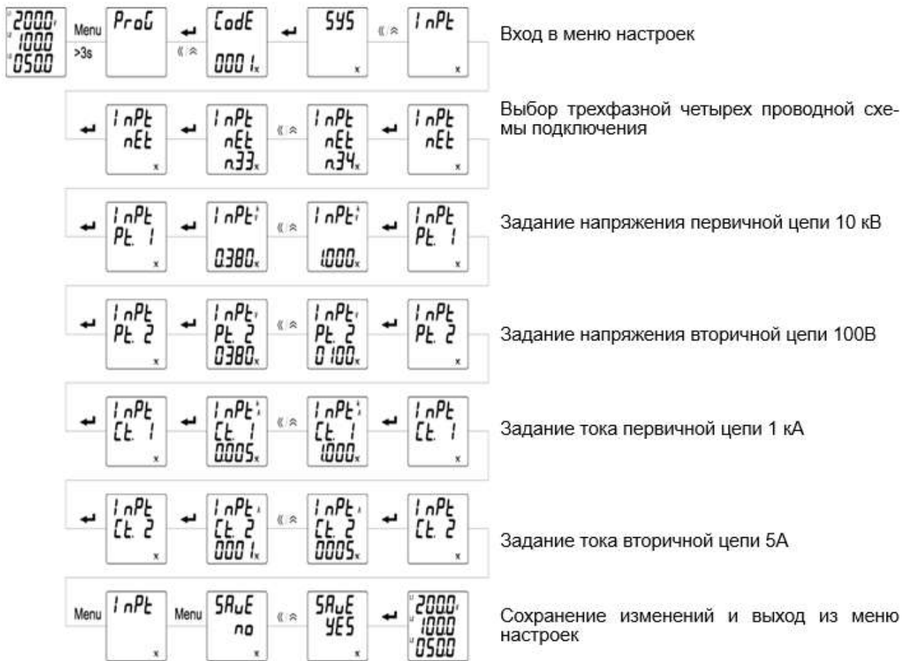
Рисунок 4.16 – Настройка параметров входных сигналов прибора PD194E-8H3T
