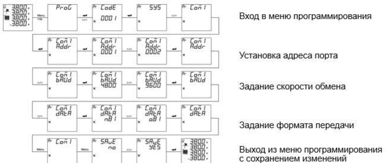
Рисунок 4.12 – Настройка параметров порта связи RS-485 прибора PD194E-9K3T
