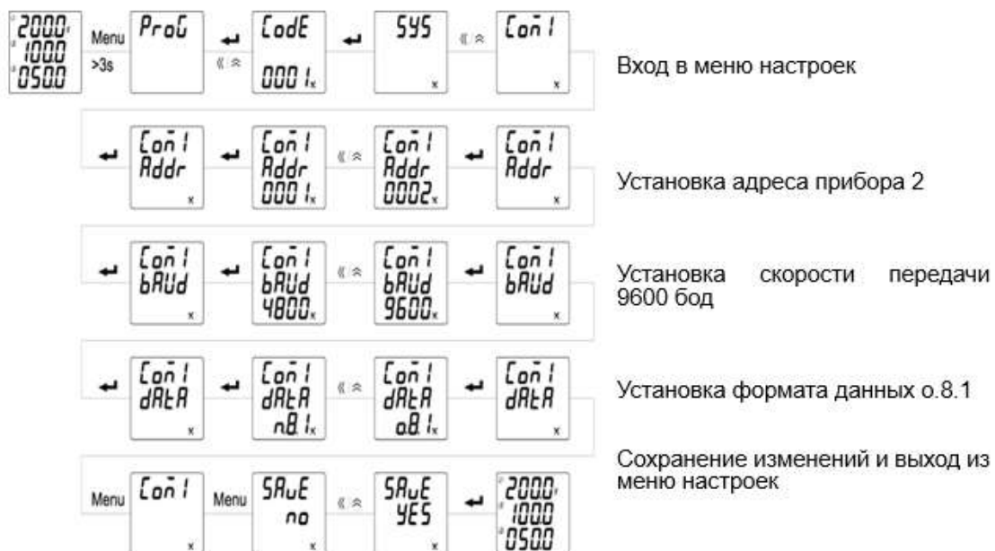
Рисунок 4.17 – Настройка параметров порта RS-485 прибора PD194E-8H3T
